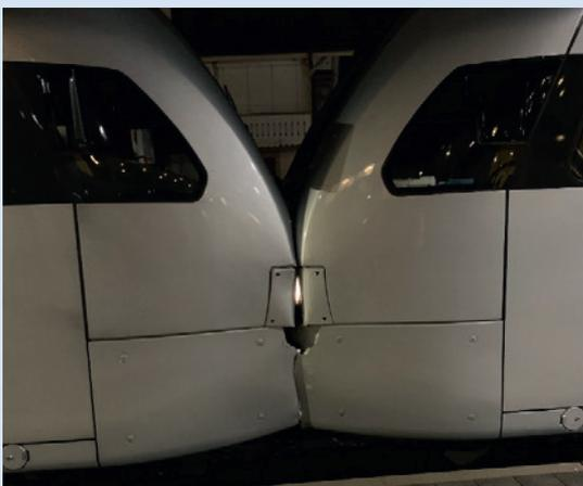
L'urto in fase di accostamento a una composizione in sosta verificatosi il 31 dicembre 2020 a Belp è da ricondurre a diverse circostanze che hanno influenzato la capacità di frenata al punto da rendere insufficiente la distanza di frenatura disponibile per arrestare in tempo il treno.
