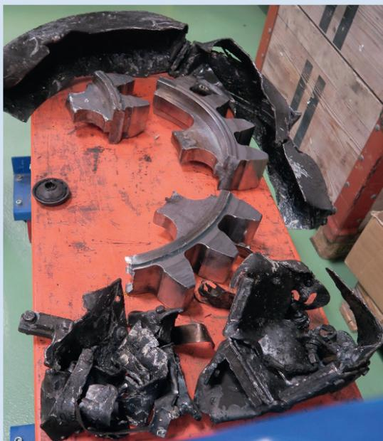
La rottura della ruota dentata motrice di un elettrotreno Adler durante la discesa verso Brünig il 6 marzo 2021 è da ricondurre a un inizio di frattura dell'alloggiamento delle molle causato da una sollecitazione eccessiva del sistema a molle tangenziali, che ha provocato un danno meccanico alla parete dell'alloggiamento e per la quale la ruota dentata motrice non era progettata.
