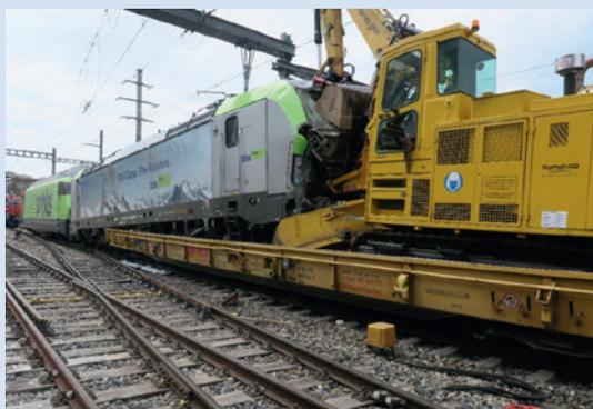
La collisione tra un treno loc con un treno merci fermo pronto alla partenza il 2 giugno 2022 a Zollikofen è da ricondurre al superamento di un segnale disposto su fermata. Il macchinista si aspettava che il segnale successivo fosse il segnale d'uscita disposto su fermata e non ha visto il gruppo di segnali presente tra il segnale d'entrata e il segnale d'uscita.
