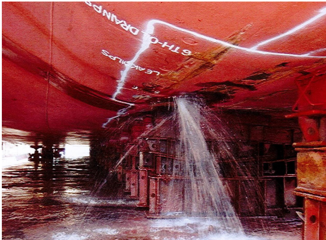
Abbildung 11: Die SABINA in Tallinn im Trockendock. Blick von achtern in Richtung des Bugs. Durchbrüche, Dellen und Kratzer in den Bereichen des backbordseitigen Doppelboden-Wasser-Ballasttanks und des Kieltunnels sowie Dellen und Kratzer in den Bereichen des backbordseitigen Doppelboden-Wasser-Ballasttanks, des Kieltunnels, des Lecköl-Tanks (Markierung «LEAK OIL PS») und des Thermoöl-Ablass-Tanks (Markierung «OIL DRAIN PS»). In den Doppelboden der SABINA eingedrungenes Wasser strömt durch die Durchbrüche des Doppelbodens hindurch ins gelenzte Trockendock.
