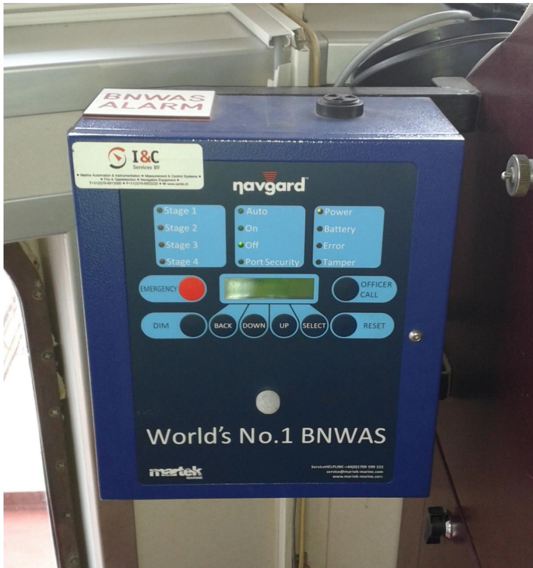
Abbildung 16: BNWAS-Bedien-Einheit («control panel»), backbordseitig direkt anschliessend an das Brückenpult auf Hüfthöhe installiert (vgl. Abbildung 17). Mittig ist die Status- und Bedien-Anzeige angebracht, darüber drei Gruppen mit je vier Status-Leuchten. Da das Gerät ausgeschaltet ist, leuchtet die Status-Leuchte «Off» grün. Darunter sowie links und rechts befinden sich acht Drucktasten. Die Drucktaste rechts unten ist die Reset-Taste. Der rote Knopf links oben ist die Emergency -Taste. Der weisse «Knopf» mittig oberhalb des Schriftzuges «World's No. 1 BNWAS» ist die Linse des integrierten Infrarot-Bewegungssensors.
