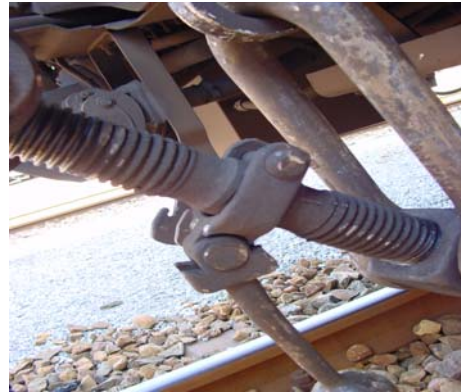
Die herunterhängende Kupplung des vorlaufenden A war für die Ueberfuhr von der Ereignisstelle ins Industriewerk Olten in den Blindhaken eingehängt worden. Auch hier sind Schlagspuren erkennbar.
