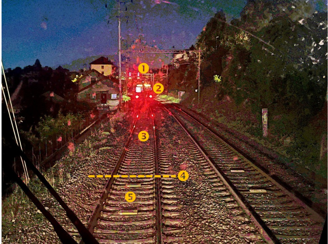
Abbildung 11: Situation nach dem Halt des Güterzuges. Bildquelle: Lf des Güterzuges. ❶ Einfahrsignale NEVS / ❷ Rangierfahrt steht auf Gleis 232 / ❸ Gleis 232 NE-NEVS / ❹ Grenze Bhf NE / Strecke / ❺ Gleis A14 NE
