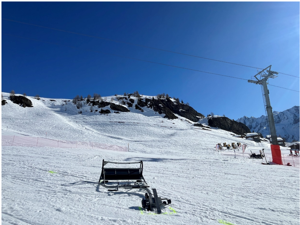
Abbildung 4: Unfallstelle: Im Vordergrund der abgestürzte Seilbahnsessel, im Hintergrund die Seilbahnanlage Stafel–Gandegg mit der Seilbahnstütze Nr. 2.
