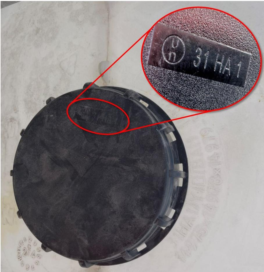
Abbildung 9: Prägung auf dem Schraubdeckel.
