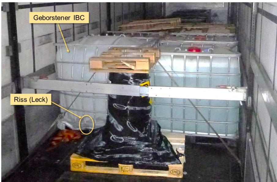
**Abbildung 3:** Blick auf die Ladung des Sattelanhängers; links der aufgeblähte und geborstene IBC, daneben drei unbeschädigte IBC. Bildquelle: Feuerwehr, bearbeitet durch SUST.
