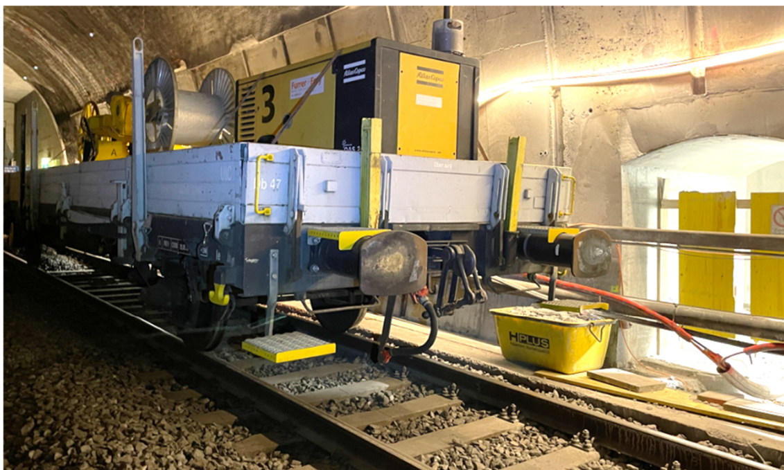
Abbildung 11: Hindernisse auf dem Bankett bei der Stelle zwischen Komposition 1 (im Bild) und Komposition 2 (nicht im Bild, weggerollt): Betonkübel, Kabel, Bretter.
