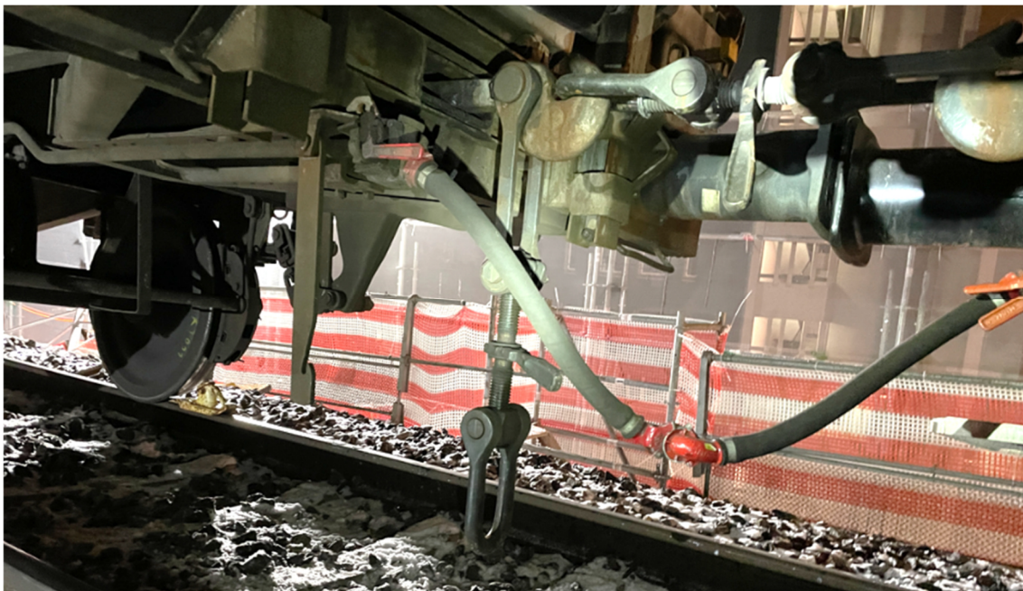
Abbildung 6: Herunterhängende Kupplung zwischen dem TWA 10 und dem Ks.
