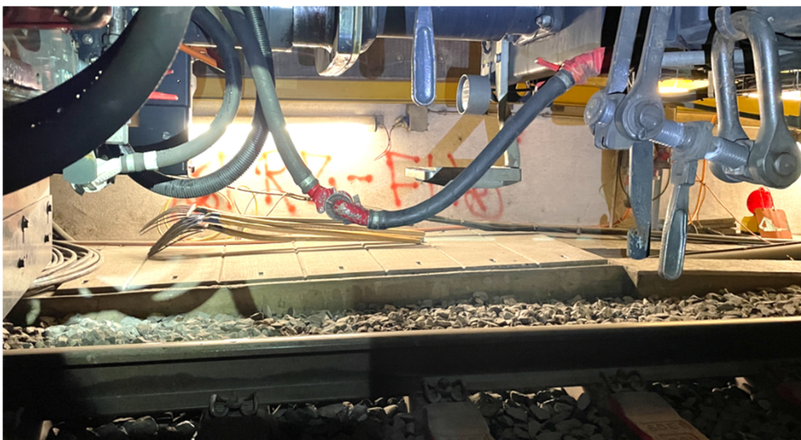
Abbildung 9: Hindernisse auf dem Bankett: Kabel, Werkzeug, Tafeln (Kuppelstelle zwischen Rangierlok und TWA 9).
