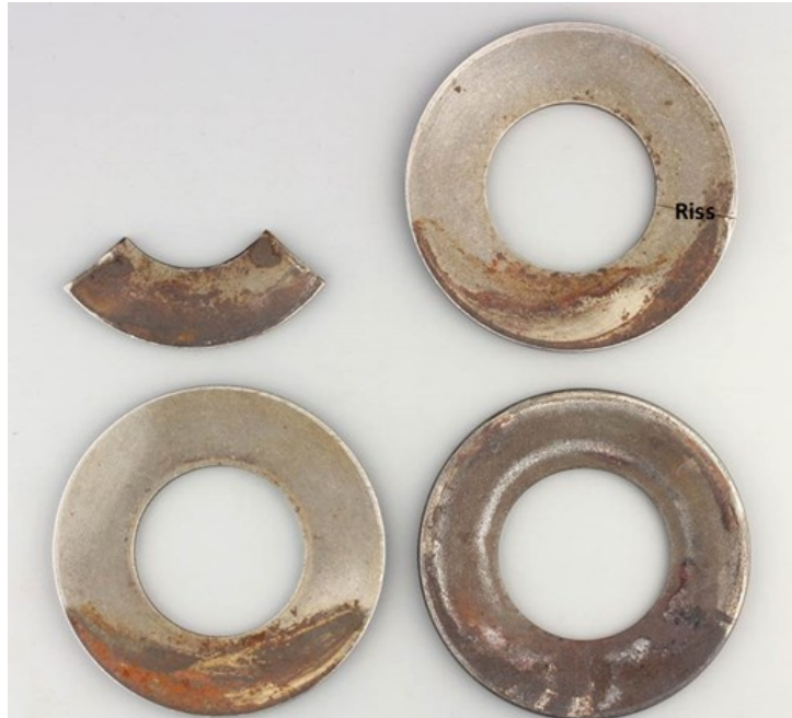
Abbildung 4: Fotografien der untersuchten Tellerfedern. Die Tellerfeder oben rechts weist einen durchgehenden Riss auf.
