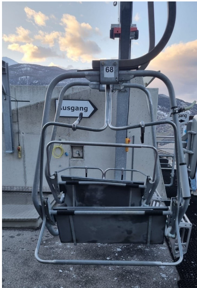
Abbildung 1: Fotografie der kollidierten Seilbahnsessel nach der Ankunft in der Talstation (Quelle: SVG).
