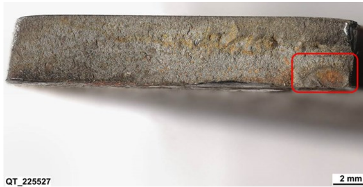
Abbildung 5: Detailaufnahme der Bruchfläche mit Korrosionsspuren.
