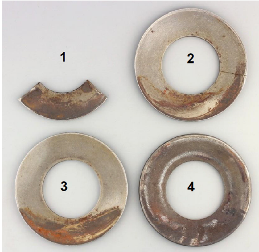
Abbildung 9: Die vier für die metallurgische Untersuchung zur Verfügung gestellten Tellerfedern aus der Seilklemme des Sessels Nr. 68 (Proben 1-4).
