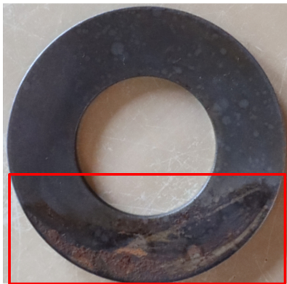
Abbildung 8: Tellerfeder aus der Federsäule des Seilbahnsessels Nr. 68. Rot markiert die im unteren Teil der Tellerfeder vorhandene Korrosion.
