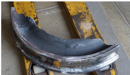
Abbildung 2: Erstes gebrochenes Radscheibenfragment (Aufnahme ausserhalb des Tunnels).
