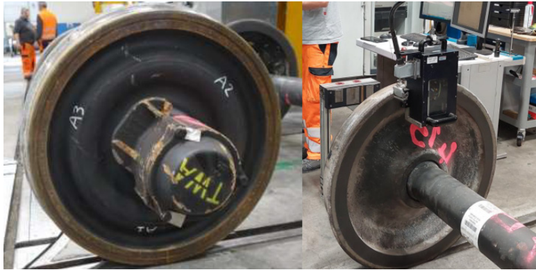
Abbildung 70: Aufnahme eines Radsatzes bei der Eigenspannungsmessung.
