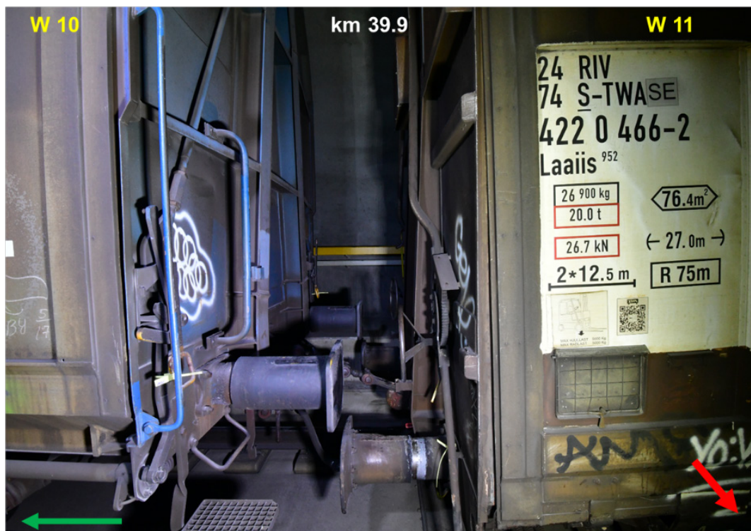
Abbildung 4: Aufnahme der Kupplung zwischen Wagen 10 und 11 nach dem Stillstand des Zuges. Im Bereich unterhalb des roten Pfeiles befindet sich die Achse 1 mit dem gebrochenen Rad des elften Wagens.
