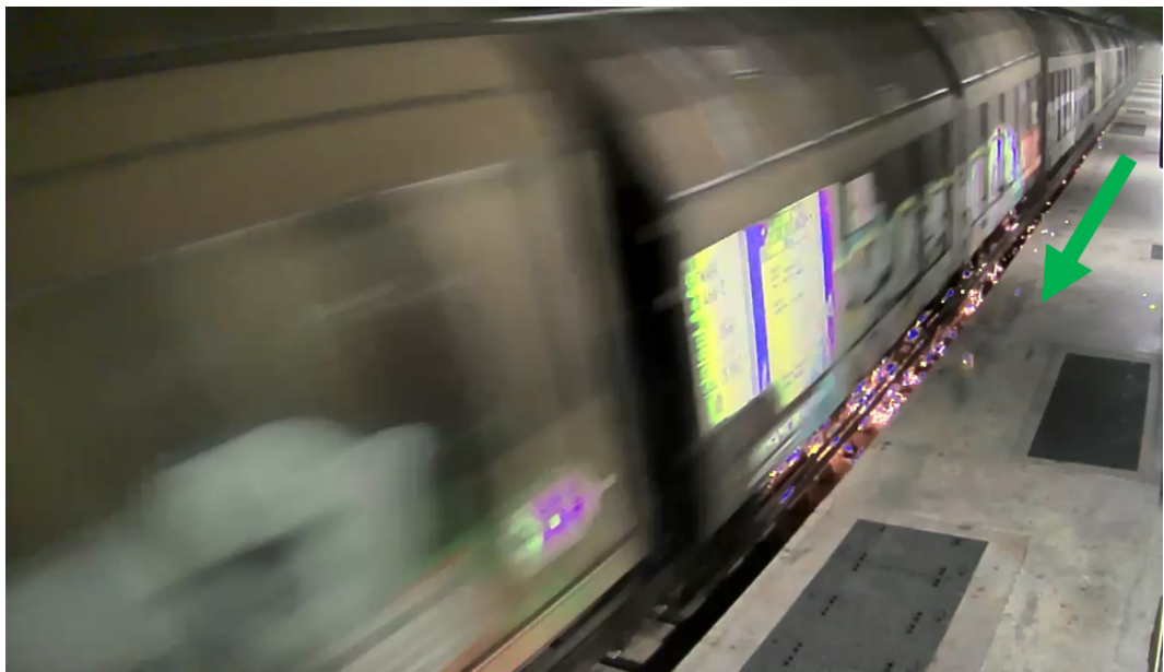
Abbildung 52: Durchfahrt des Zuges in der MFS Faido (ca. km 40.8). Funkenbildung durch die Bremsdreiecke und von Achse 1, Wagen 11. Gut sichtbar ist auch der einseitig tiefer hängende Wagenkasten von Wagen 11 (Quelle: Bild aus der Videoüberwachung der MFS Faido der SBBI).
