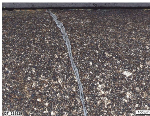
Abbildung 76: Mikroschliff, Risse mit Produkten gefüllt.
