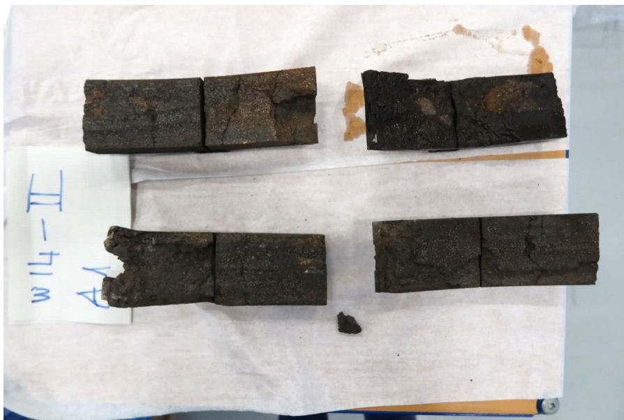
Abbildung 71: Bremssohlen der ersten Achse von Wagen 14-2.
