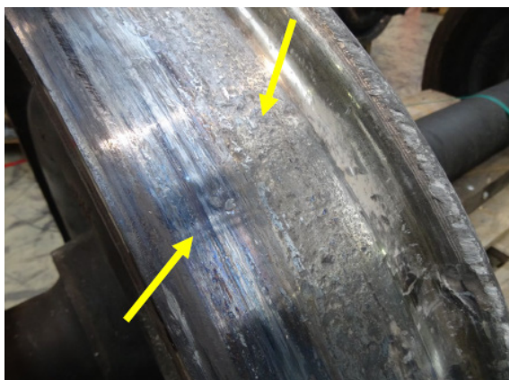
Abbildung 83: Blaue Verfärbung der Lauffläche. Gelbe Pfeile: Rissanzeichen.
