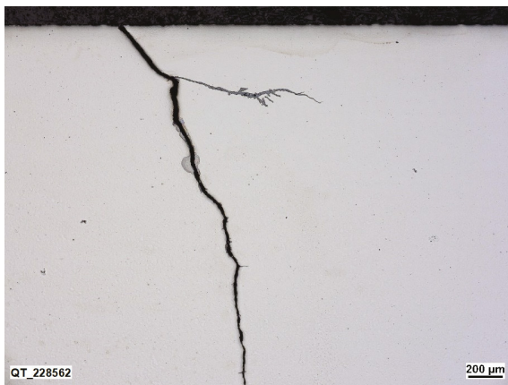
Abbildung 87: Fraktografische Untersuchung der Risse.
