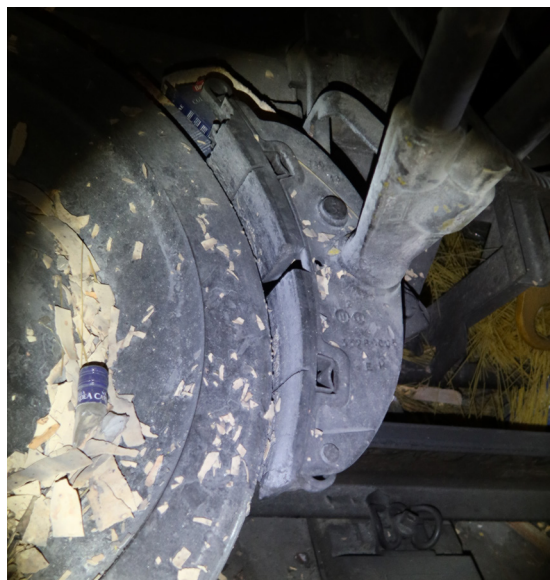
Abbildung 12: In Fahrtrichtung rechtes Rad der Achse 4 von Wagen 14-2. Die hintere Wagenhälfte durchbrach das Spurwechseltor nicht und kam davor zum Stillstand. Die Achse hing an ihrer ursprünglichen Position, die Bremsen waren gelöst.
