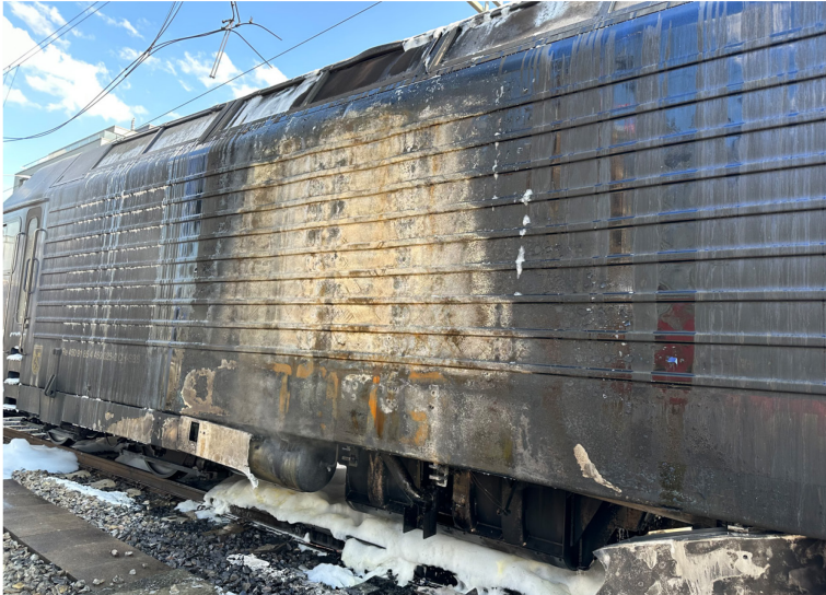
Abbildung 2: Lok Re 450 025 nach dem Löschen des Brandes.
