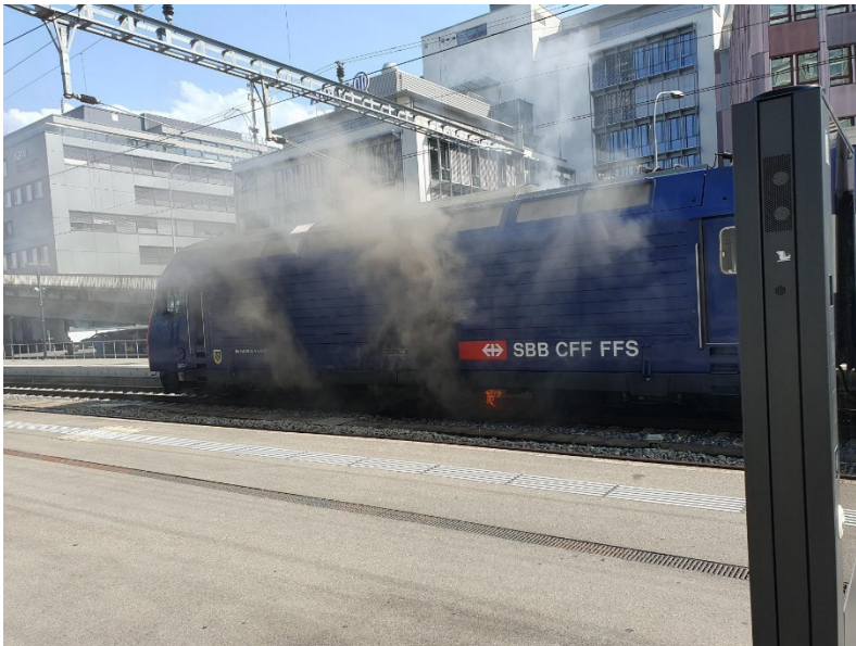
Abbildung 1: Ankunft in Zürich Altstetten: Nebst Rauch sind auch Flammen unter der Lokomotive beim Trafo sichtbar (Quelle: SBB).
