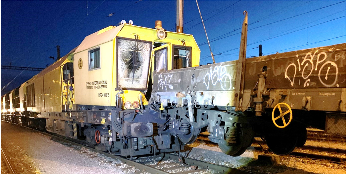
Abbildung 2: Situation nach der Kollision der Rangierbewegung mit der abgestellten Baumaschine.
