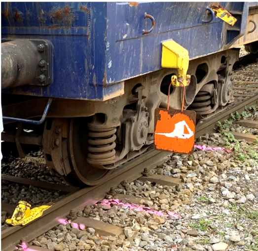
Abbildung 7: An der Entkuppelstelle aufgelegter Hemmschuh und am entkuppelten Wagen angebrachte Hemmschuhwarntafel.
