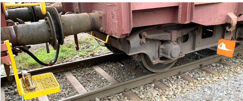
Abbildung 8: Bei der Kuppelstelle zwischen dem zweiten und dritten Wagen bereitgelegter Hemmschuh und angebrachte Hemmschuhwarntafel.
