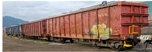
Abbildung 5: Offene Güterwagen der Bauart Eaos/Fas
