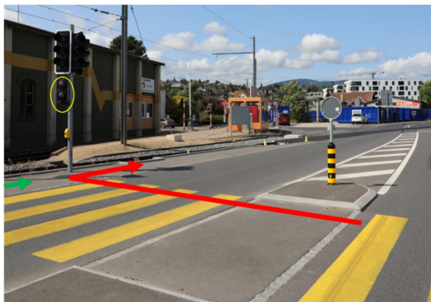
Illustration 13 : Vue du passage piéton : Cercle jaune feu piéton interdisant la poursuite de la marche à un piéton lorsqu'un itinéraire de manœuvre est établi sur la voie de raccordement Nestlé. (Source : Police VD, adjonctions SESE.)
