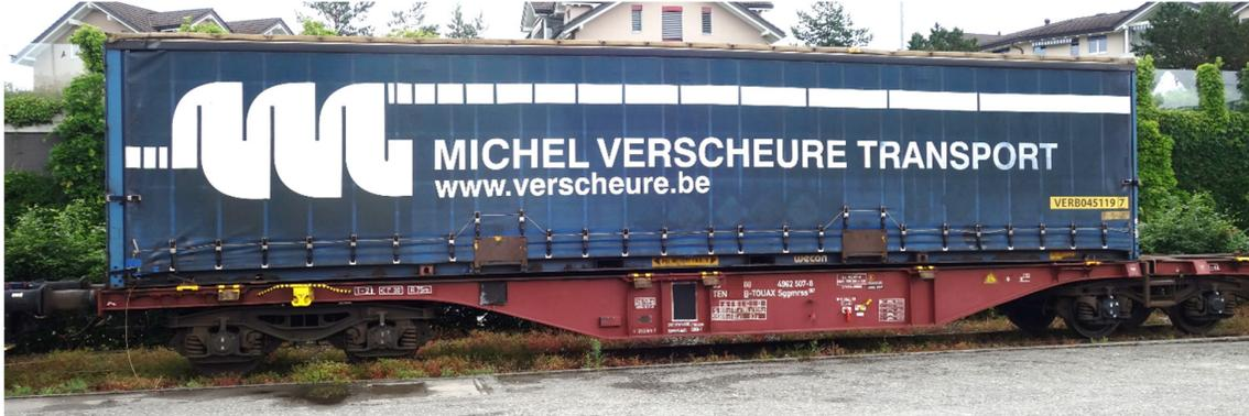
**Abbildung 2:** Ein auf einem Container-Tragwagen verladener Wechselbehälter.
