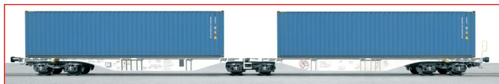
**Abbildung 4:** Containertragwagen mit Typenbezeichnung Sggmrs (Musterbild, Quelle: VTG AG).
