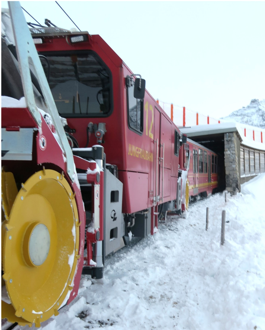
Abbildung 2: Im Vordergrund die Schneefrässchleuder, dahinter der aus der Galerie gekommene und aufgefahrene Personenzug.
