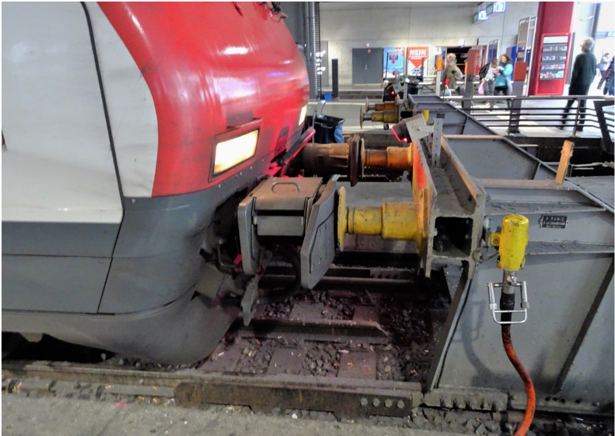
Abbildung 1: Steuerwagen mit den eingedrückten Puffern und Prellbock im Gleis 6.
