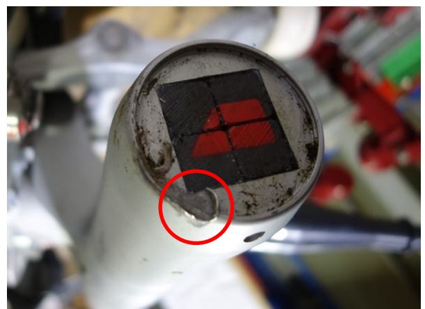
Abbildung 8: Detail von Abbildung 6: Torsionsfedertopf der Kuppelklemme mit Anschlagspur (Kreis).
