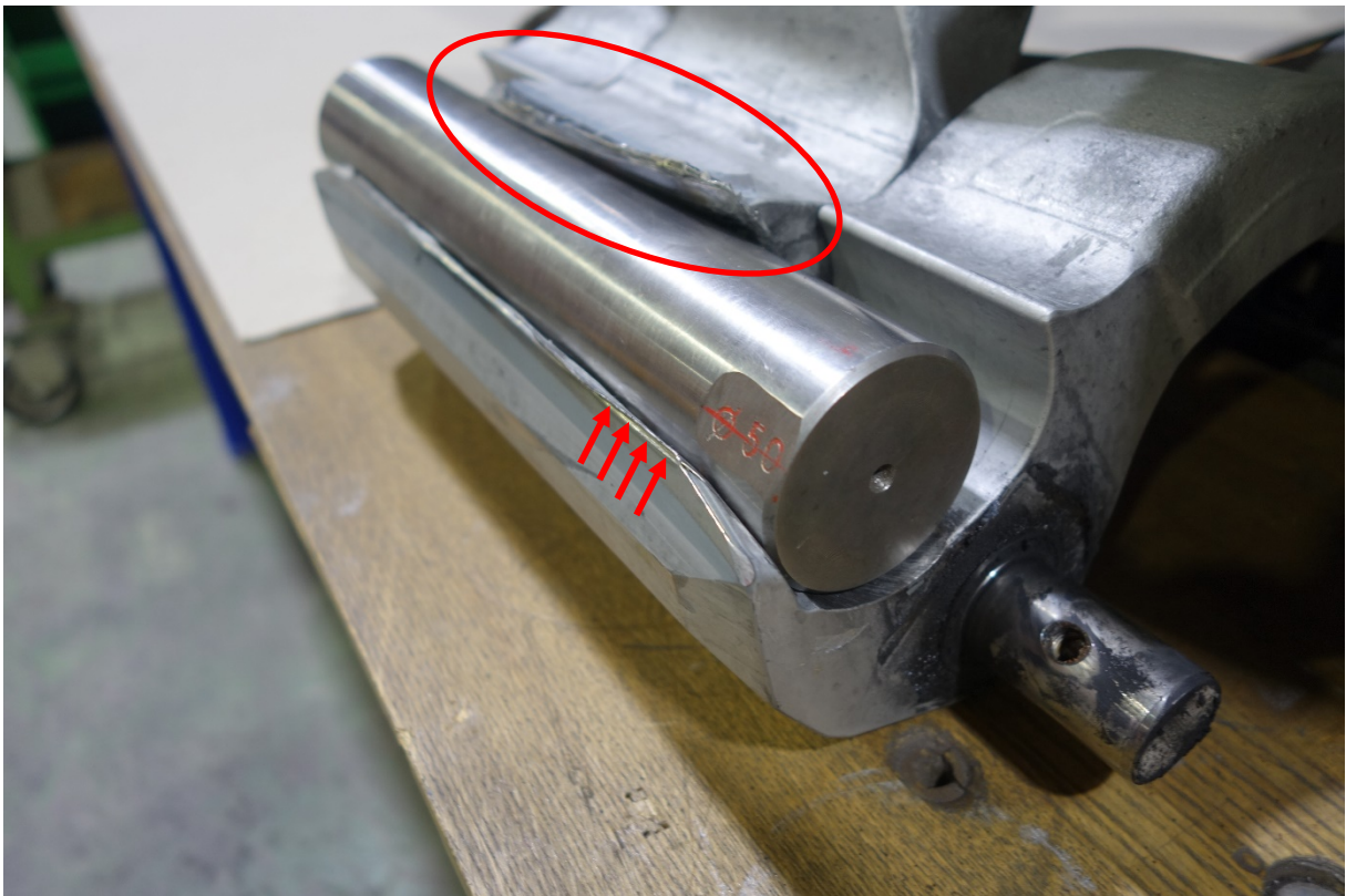
Abbildung 9: Die Kuppelklemme zeigt Spuren einer gewaltsamen Trennung vom Förderseil (Oval und Pfeile, Ansicht von der Unterseite).
