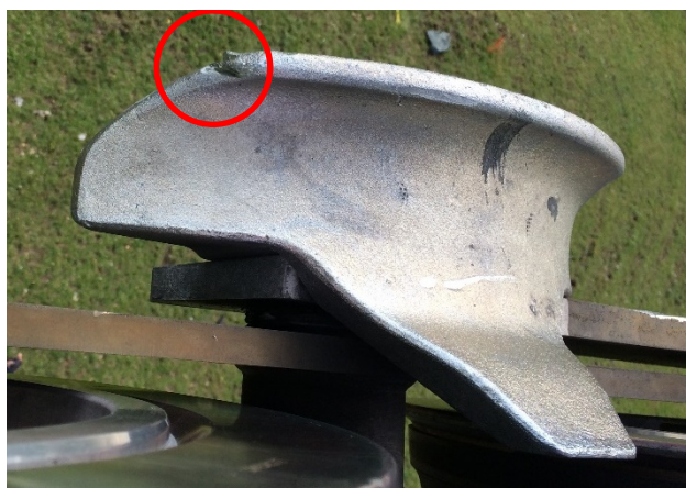
Abbildung 7: Detail von Abbildung 6: Seilfänger mit Anschlagspur (Kreis) und Schabspuren.
