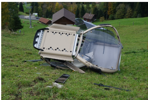
Abbildung 3: Schadensbild der Seilbahnkabine (Ansicht der Kabinenunterseite, Blickrichtung Tal).
