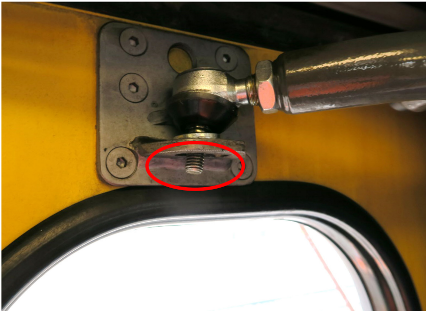
Illustration 2 : L'écrou de fixation du bras d'articulation manque (cercle rouge).
