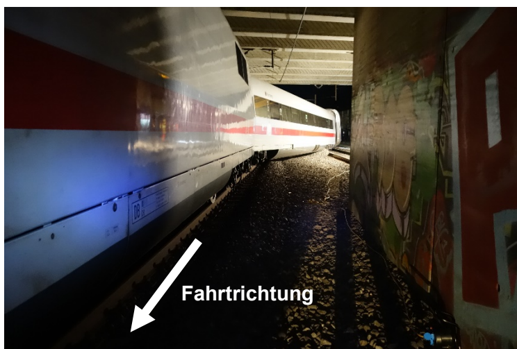
Abbildung 1: Lage des entgleisten Wagens nach dem Stillstand.
