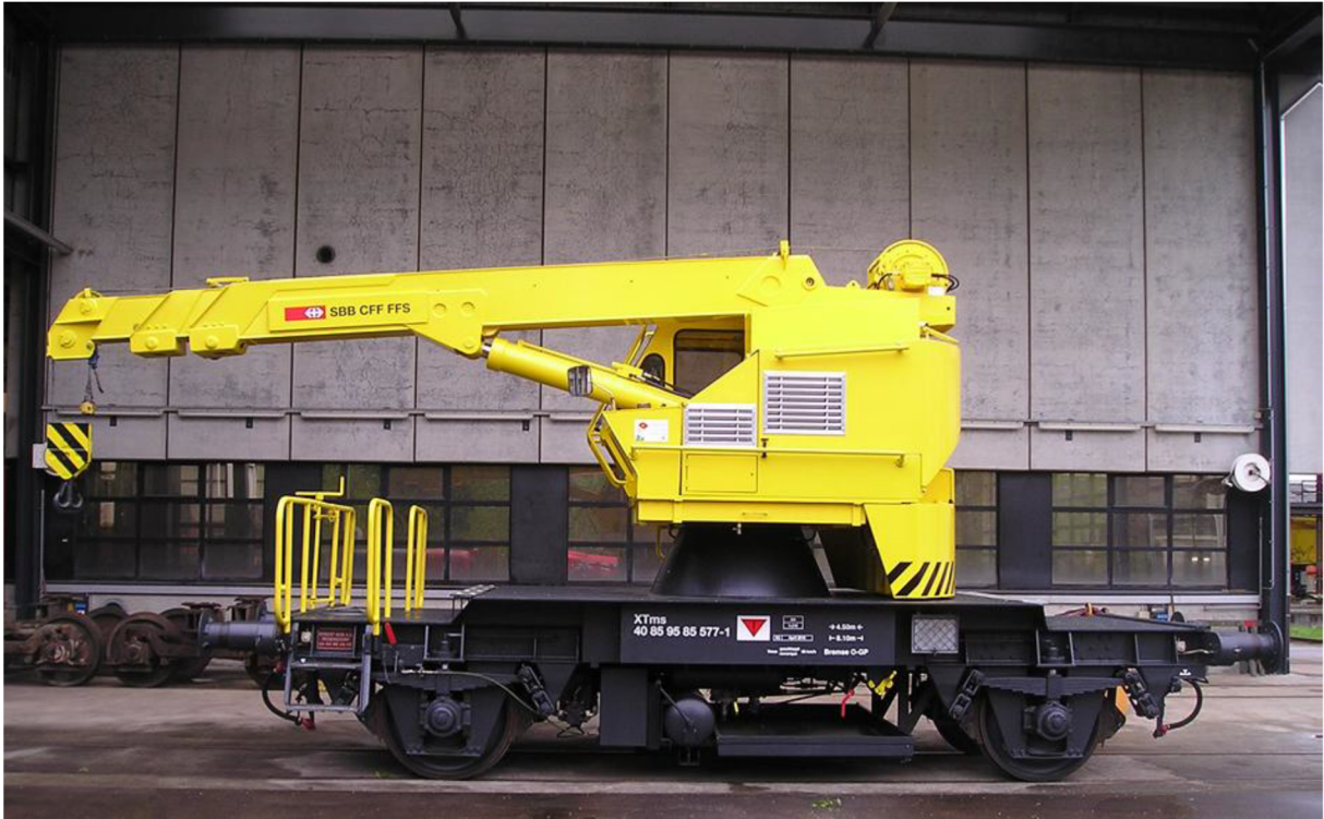
Abbildung 1: Schienenkran «Bendini» (Bild: SBB).
