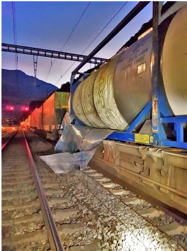
Abbildung 1: Lose Blechverschalung in Bellinzona San Paolo. (Quelle: SBB).
