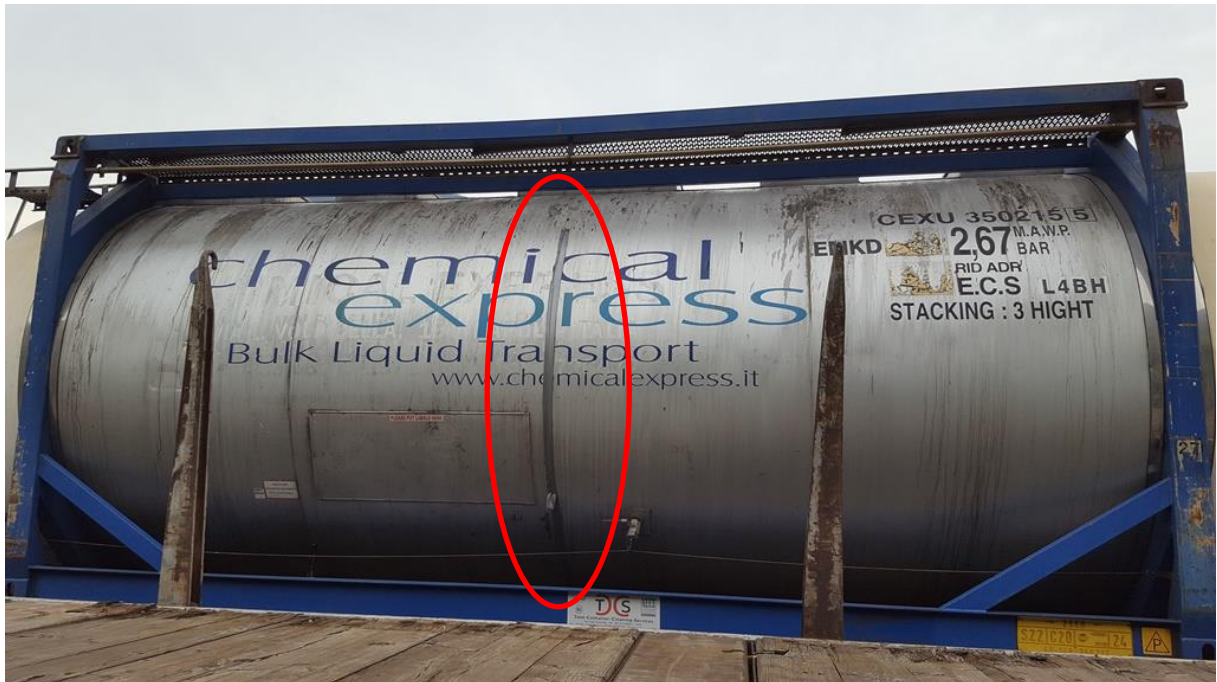
Abbildung 5: Geklebte Verbindungsstelle zweier Blechsegmente (rotes Oval).
