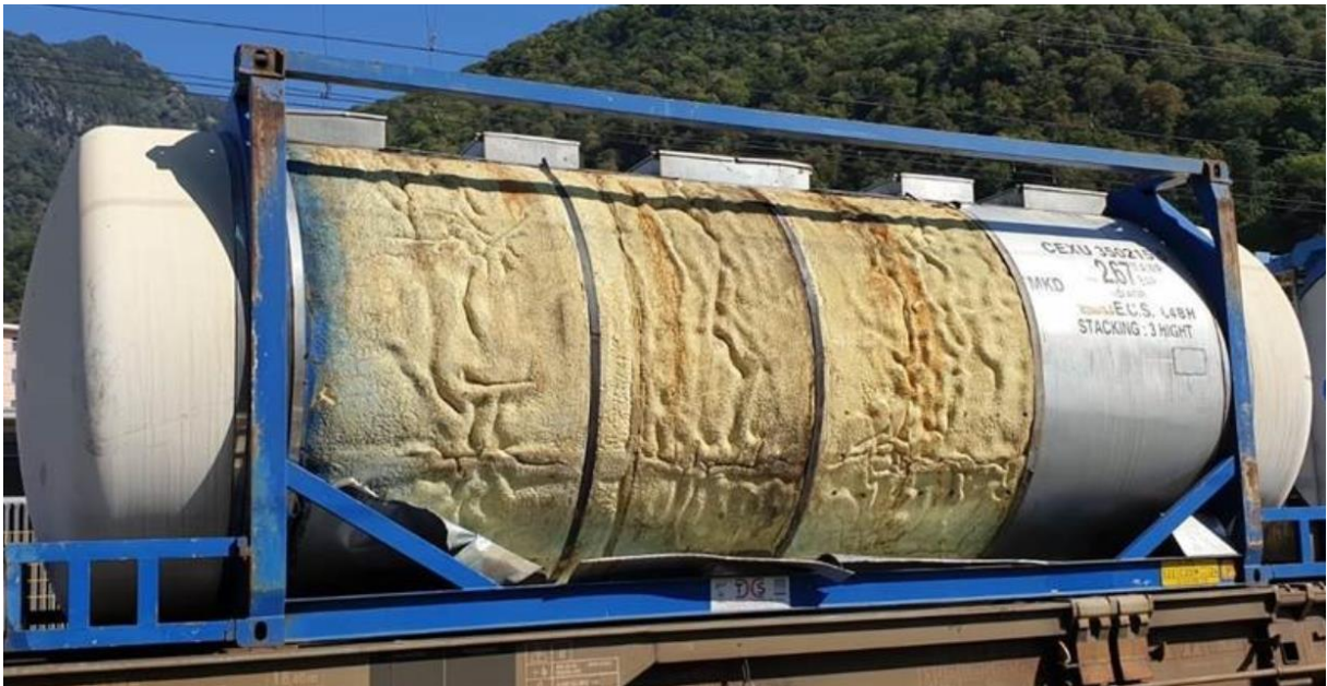
Abbildung 2: Drei Segmente der Blechverschalung haben sich gelöst. (Die Bleche sind auf dieser Abbildung bereits durch die Intervention der SBB abgetrennt worden.)
