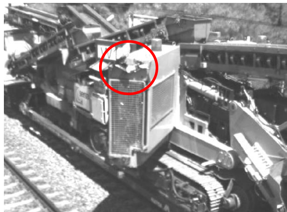
Abbildung 6: Durchfahrt Profilotungsanlage in Claro. Die Führerkabine ist ausgeschwenkt und beschädigt (Kreis) (Quelle: SBB).
