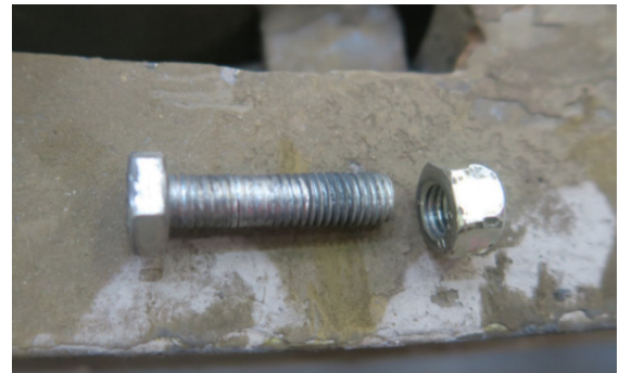
Abbildung 16: Befestigungsschraube des Nothalterungsträgers der Bremsgestänge, Gewinde abgenutzt.
