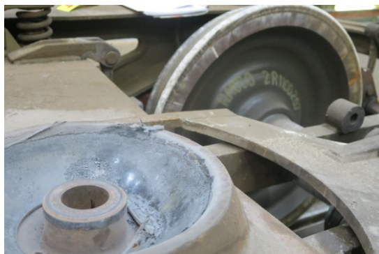
Abbildung 9: Beschädigte Kunststoffgleiteinlage der Drehpflanzen und metallische Schleifspuren im oberen Bereich der Drehpfanne.
