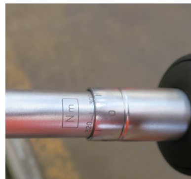
Abbildung 25: Gemessenes Anzugsdrehmoment von 320 Nm.
