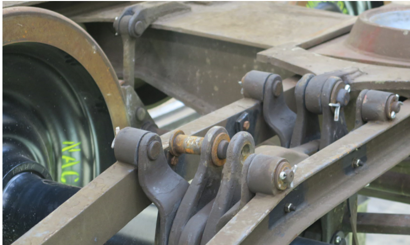
Abbildung 23: Bolzen der Bremsgestänge ohne Schmierung.
