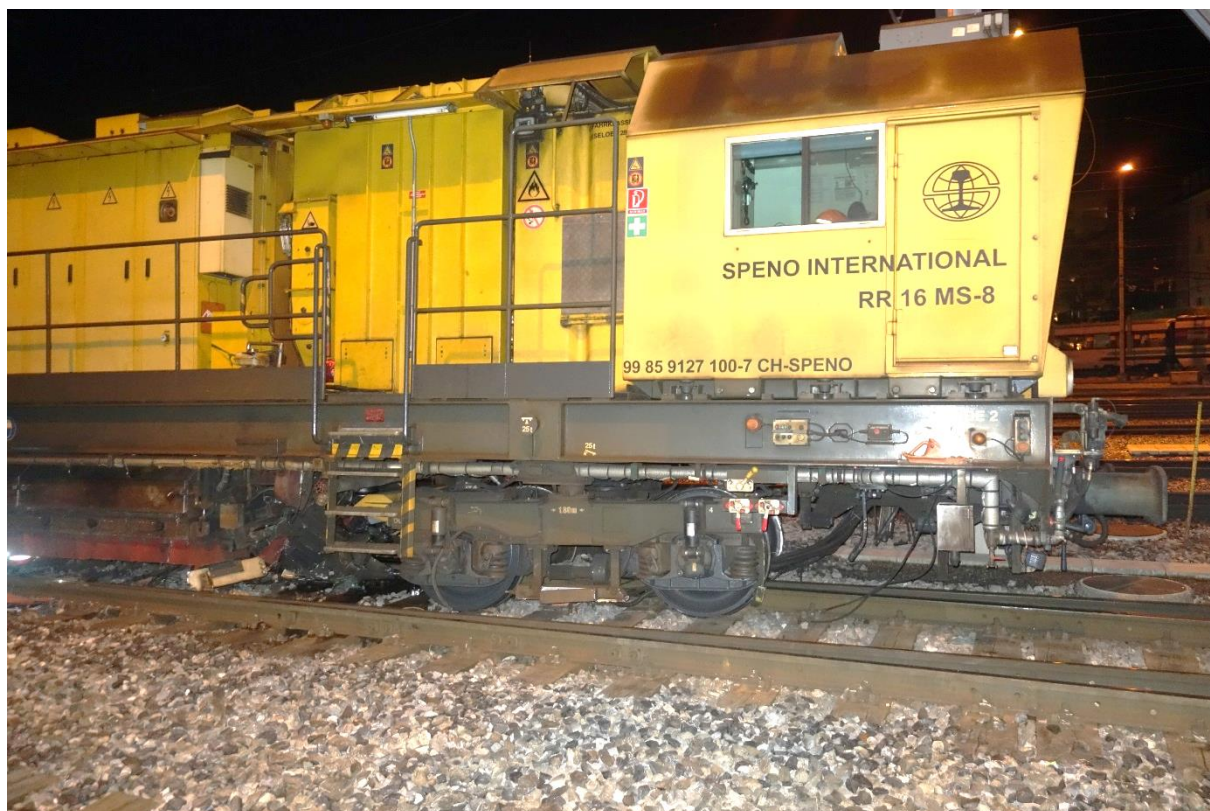
Abbildung 3: Entgleistes Drehgestell der Schienenschleifmaschine.
