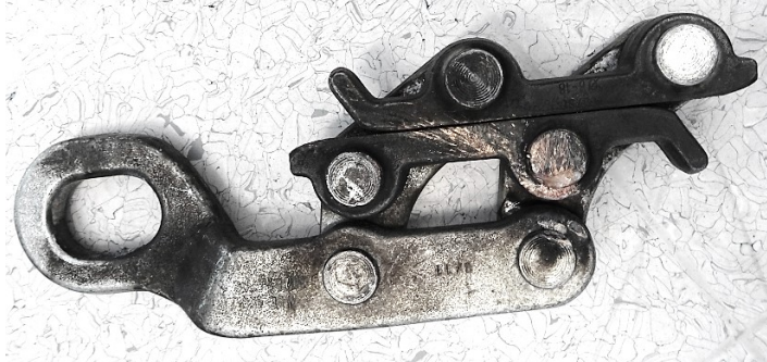
Abbildung 6: Frosch zum Abspannen der Fahrleitung.
