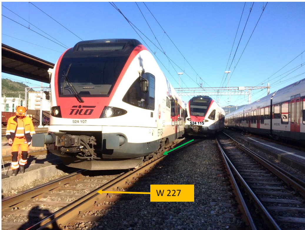
Abbildung 2: Endlage der beiden Triebzüge nach der seitlichen Kollision. Vorne: Triebzug RABe 524 107; hinten: Triebzug RABe 524 115
