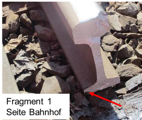
Abbildung 6: Aufnahme der Bruchstelle. Rot markiert ist eine auffällige Markierung im Fussbereich von Fragment 1.
