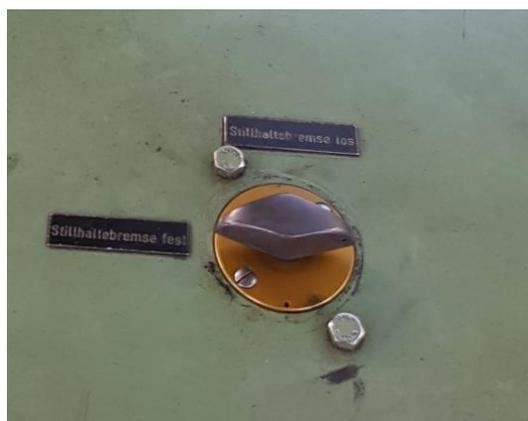
**Abbildung 5:** Hahn für die Federspeicherbremse auf dem Führerpult in der Position „fest“ (Anschrift Stillhaltebremse fest).
