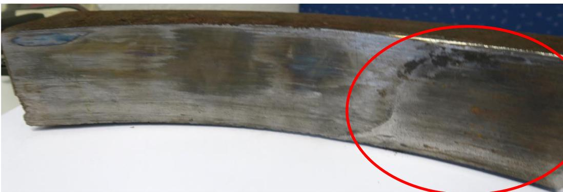
**Abbildung 13:** Rangiertraktor Tm 4972; Verfärbungen der Lauffläche einer Federspeicherbremssohle nach ca. 1500 m Fahrt der am 1. September 2016 entlaufenen Komposition; roter Kreis: Fläche, die keinen Kontakt mit dem Rad hatte.
