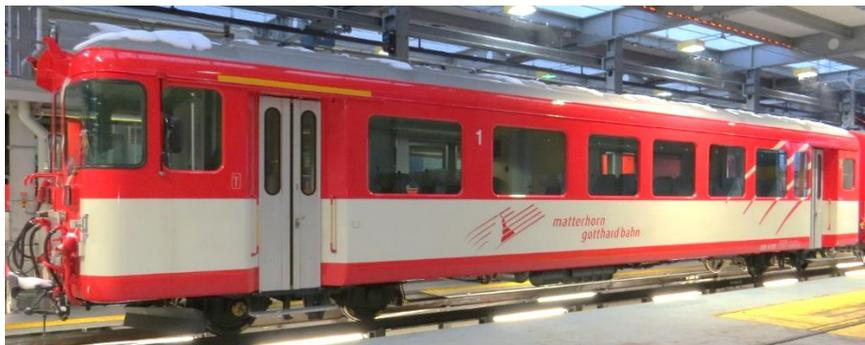
**Abbildung 12:** Steuerwagen ABt (Quelle: MGB).
