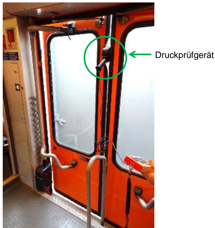
Abbildung 7: „Geschlossene und verriegelte“ Türe des Be 556 525 mit eingeklemmtem Druckprüfgerät.
