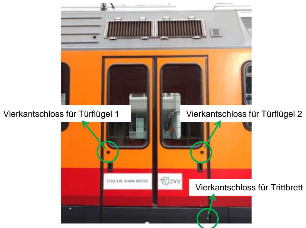
Abbildung 5: Mechanische Verriegelungen bei der manuellen Abtrennung von Türen (bei Störungen)
