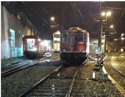
Abbildung 1: Standort der Re 420 11147 nach der Entgleisung. Das Weichensignal und der Stellhebel der Handweiche 933 zeigen bereits den Zustand nach der Reparatur
