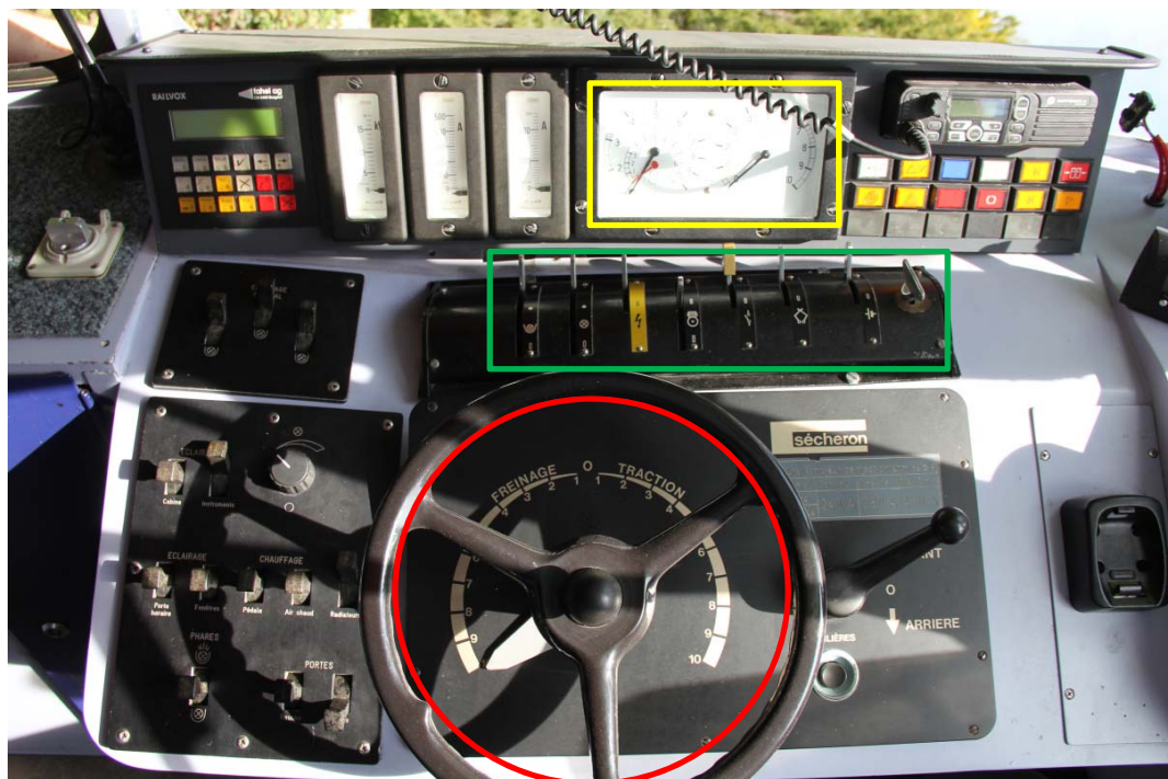
Illustration 4: table de mécanicien de la voiture de commande BDt n°53; cadre vert : coffret de commande ; cadre jaune : manomètres ; cercle rouge : combinateur.
