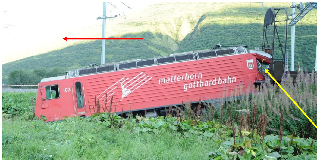
Abbildung 3: Auf dem Bild ist die entgleiste Lok in der Endlage sichtbar. Der rote Pfeil markiert die Fahrtrichtung des Zuges, der gelbe Pfeil den beschädigten Führerstand 2.
