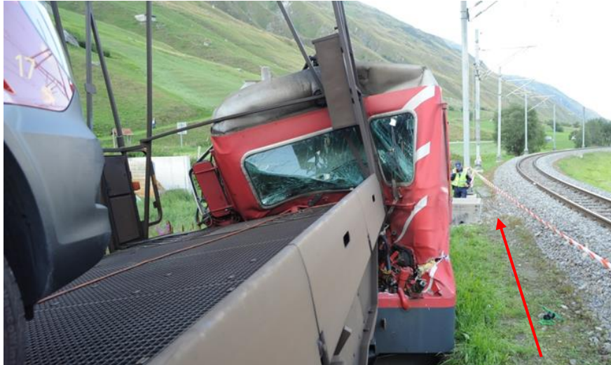
Abbildung 6: In der Bildmitte ist der beschädigte Führerstand 2 der Lok 103 sichtbar. Der rote Pfeil zeigt die Fahrtrichtung des Zuges.
