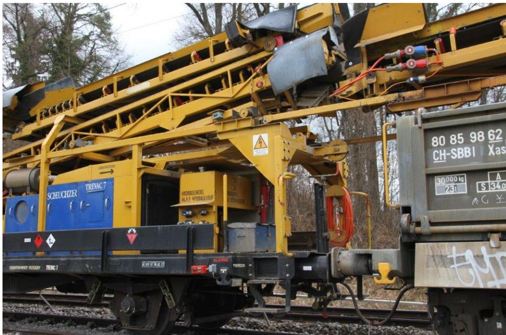
**Abbildung 17:** Vorderer Teil eines Materialübergabewagens „Trevac 6“. In dieser Abbildung zusammgekuppelt mit einem Altschotterkippwagen.
