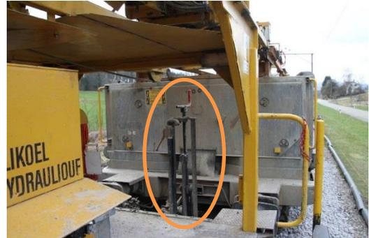
**Abbildung 19:** Sicht nach vorne mit der Handkurbel und dem Bremsventil (orangefarbenes Oval).
