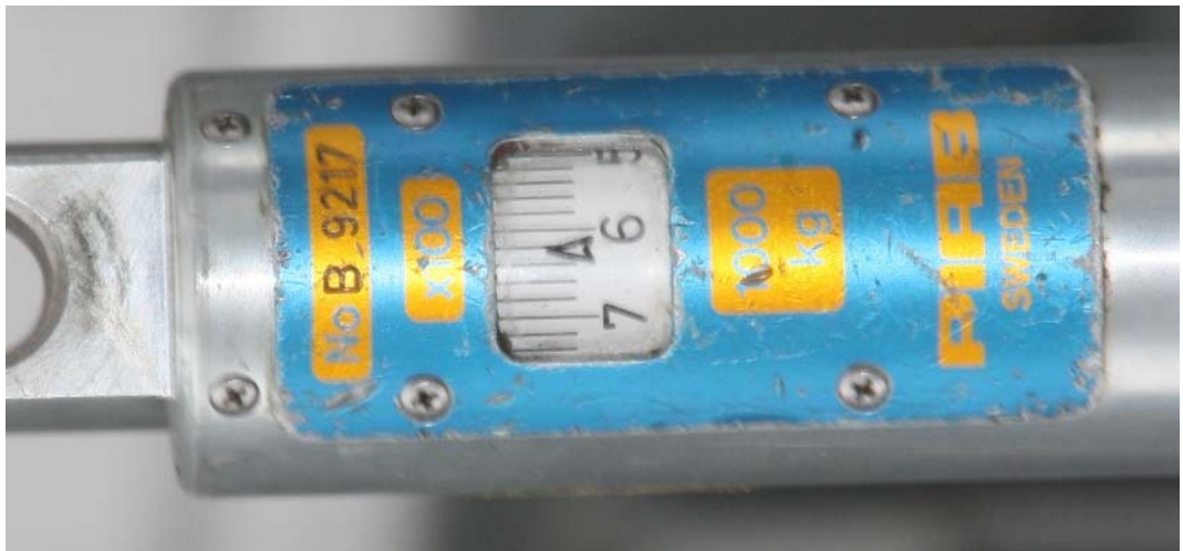
Figure 4: Dynamomètre utilisé lors du contrôle de la force d'ouverture de la pince.
