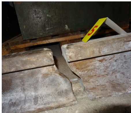
Abbildungen 11 + 12: Fotos des vermuteten ersten Schienenbruches (Quelle: SUST).
