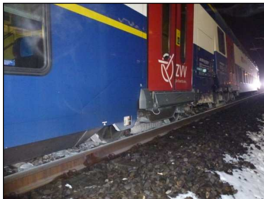
Abbildungen 2 und 3: Zug 20051 nach der Entgleisung (Quelle: SUST).
