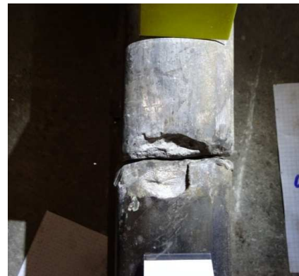
Abbildungen 11 + 12: Fotos des vermuteten ersten Schienenbruches (Quelle: SUST).
