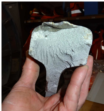
Abbildung 13: Materialablösung aufgrund von Rollkontaktermüdung 2-4 mm unter der Oberfläche (Quelle SUST).
