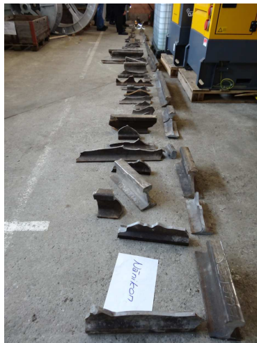
Abbildung 10: Sichergestellten Schienenstücke in Rapperswil (Quelle: SUST).
