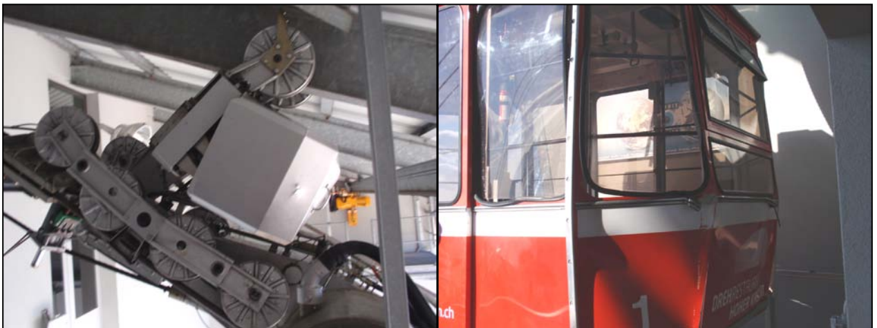
Beschädigtes Laufwerk (Kabine Bergstation)
