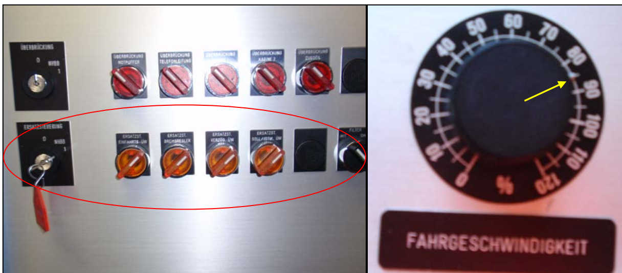
Festgestellter Zustand nach dem Unfall: Ersatzsteuerung eingeschaltet (siehe auch Anlage 1)
