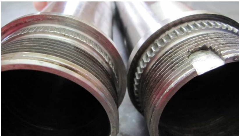
Foto 10: beschädigtes Zentralrohr mit abgeschserter Verzahnung (links), unbeschädigtes Zentralrohr (rechts)
