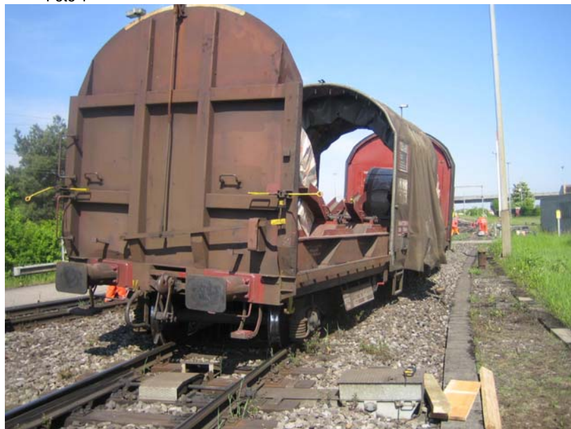
Entgleister Shimmns in Richtung Hauptablaufberg gesehen
