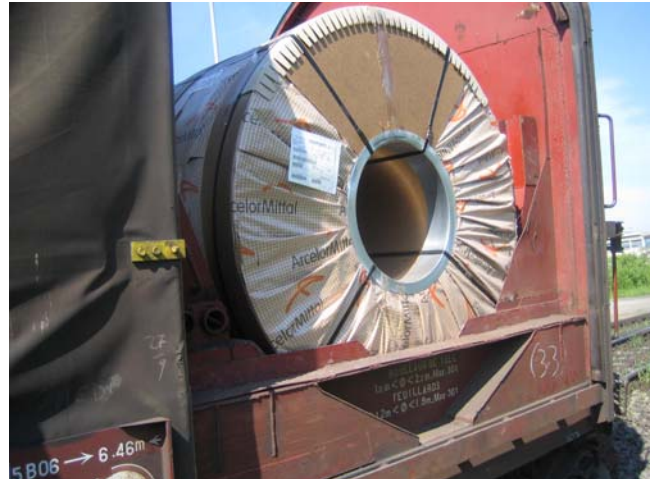
Verschobene Stahlrolle, die Sicherungsarme sind nach oben geklappt.
