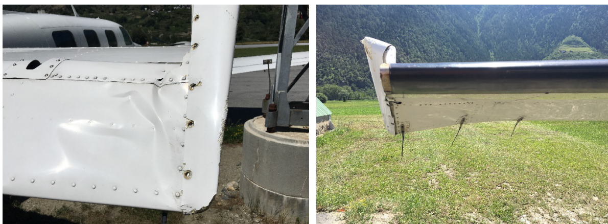
Abbildungen 1: Leicht beschädigter rechter Randbogen sowie Ausgleichsfläche des Höhenruders nach der Kollision mit dem Mast des Windsacks
