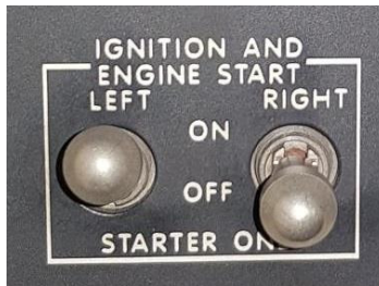
Abbildung 3: Drei-Positionen-Schalter IGNITION AND ENGINE START; linker Schalter in ON-, rechter Schalter in OFF Position.
