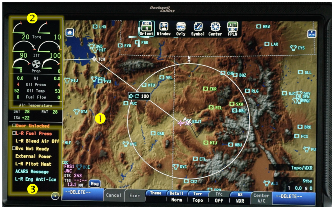
Abbildung 2: Links von der Kartendarstellung (①) und unterhalb der Anzeigen zur Überwachung der Motoren (②) werden optional Meldungen und Warnungen (③) angezeigt. In der N7779V war diese Option nicht aktiviert (Bild bearbeitet durch die SUST).
