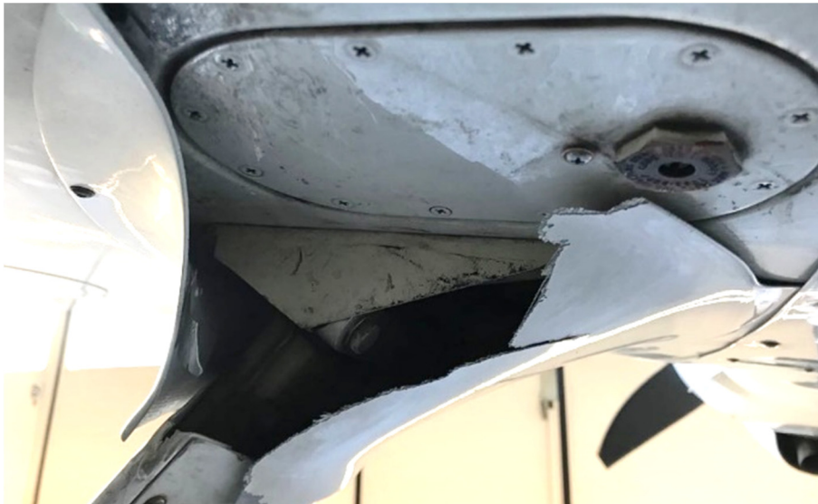
Figura 1: Carenatura del carrello di sinistra rotta, nel punto di collegamento del braccio del carrello alla fusoliera, vista in direzione di volo.
