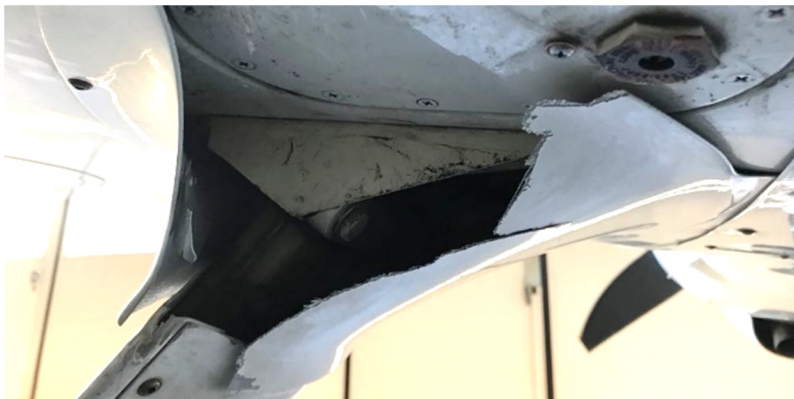
Abbildung 1: Abgebrochene linke Fahrwerkverkleidung am Übergang vom Rumpf zur Fahrwerkschwinge, in Flugrichtung gesehen.
