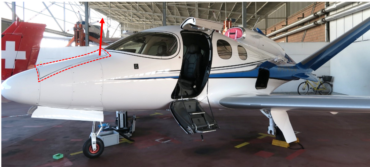
Abbildung 4: Ausschussöffnung des CAPS (rot gestrichelt) auf der vorderen Rumpfoberseite und Ausschussrichtung der Rakete für den Rettungsfallschirm (roter Pfeil).
