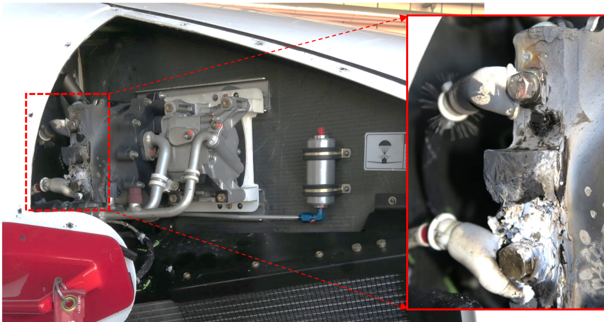
Abbildung 2: Innenbereich der rechten Rumpfspitze: Kompressor der Klimaanlage mit Brandspuren an den elektrischen Anschlüssen (oben: Minuspol, unten: Pluspol) sowie Brandrückstände im gesamten rechten Rumpfinnern.
