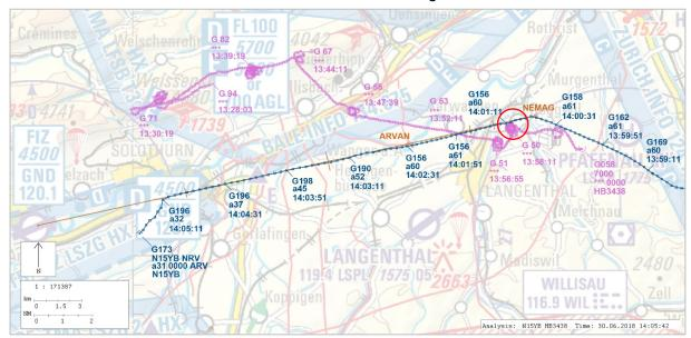
**Abbildung 1:** Flugweg der N15YB (blau) im Instrumentenanflug auf Grenchen (LSZG) und der HB-3438 (magenta) ohne Höhenübermittlung (\*\*\*) gemäss Radaraufzeichnungen mit Angaben zu Geschwindigkeiten (G) über Boden in Knoten, Höhen (a) in Hektofuss QNH und Zeit in UTC. Ort der gefährlichen Annäherung bei Roggwil (BE) auf ungefähr 6000 ft AMSL (roter Kreis). Quelle der Basiskarte: Bundesamt für Landestopografie Basiskarte.
