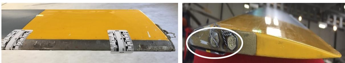
**Figura 3:** tracce dell'impatto, a sinistra sul bordo d'attacco e a destra deformazione a livello dell'intradosso
