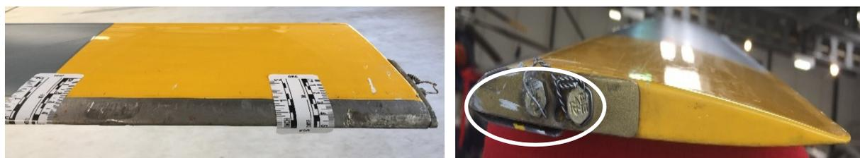
**Figure 3 :** Traces d'impact à gauche sur le bord d'attaque et déformation sur l'intrados à droite
